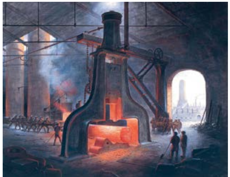
El vapor se aplicó al movimiento del martillo de forja (1769).
