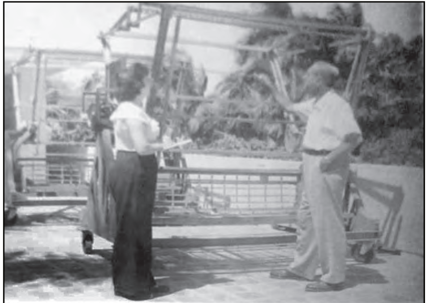
Un aparato visto de cerca sin los prismas de cuarzo y los filtros de Salaix y vidrio de Wood.
