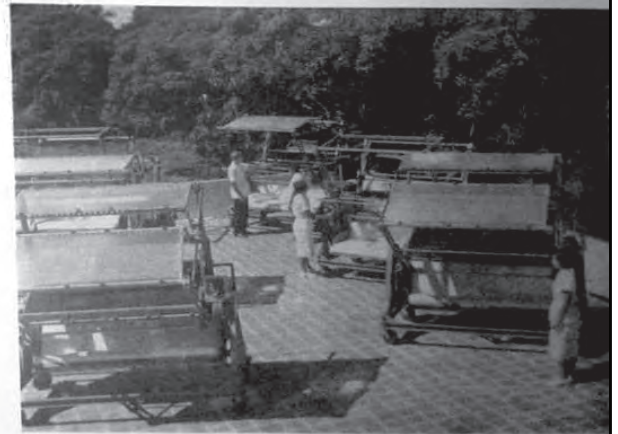
Los aparatos de helioterapia tienen cristales de distinta naturaleza para modificar a voluntad la radiación solar aumentándola con prismas especiales o disminuyéndola con filtros de infrarrojo o ultravioleta mediante filtros.
