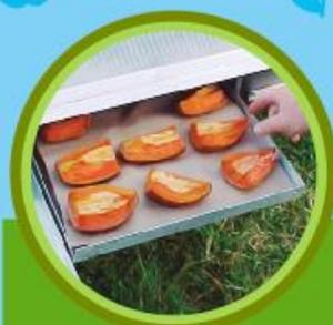
**Secador solar:** Equipo o instalación que utiliza la radiación solar como fuente de energía para disminuir la humedad del producto o material que se desea secar, sin alterar su composición química.
