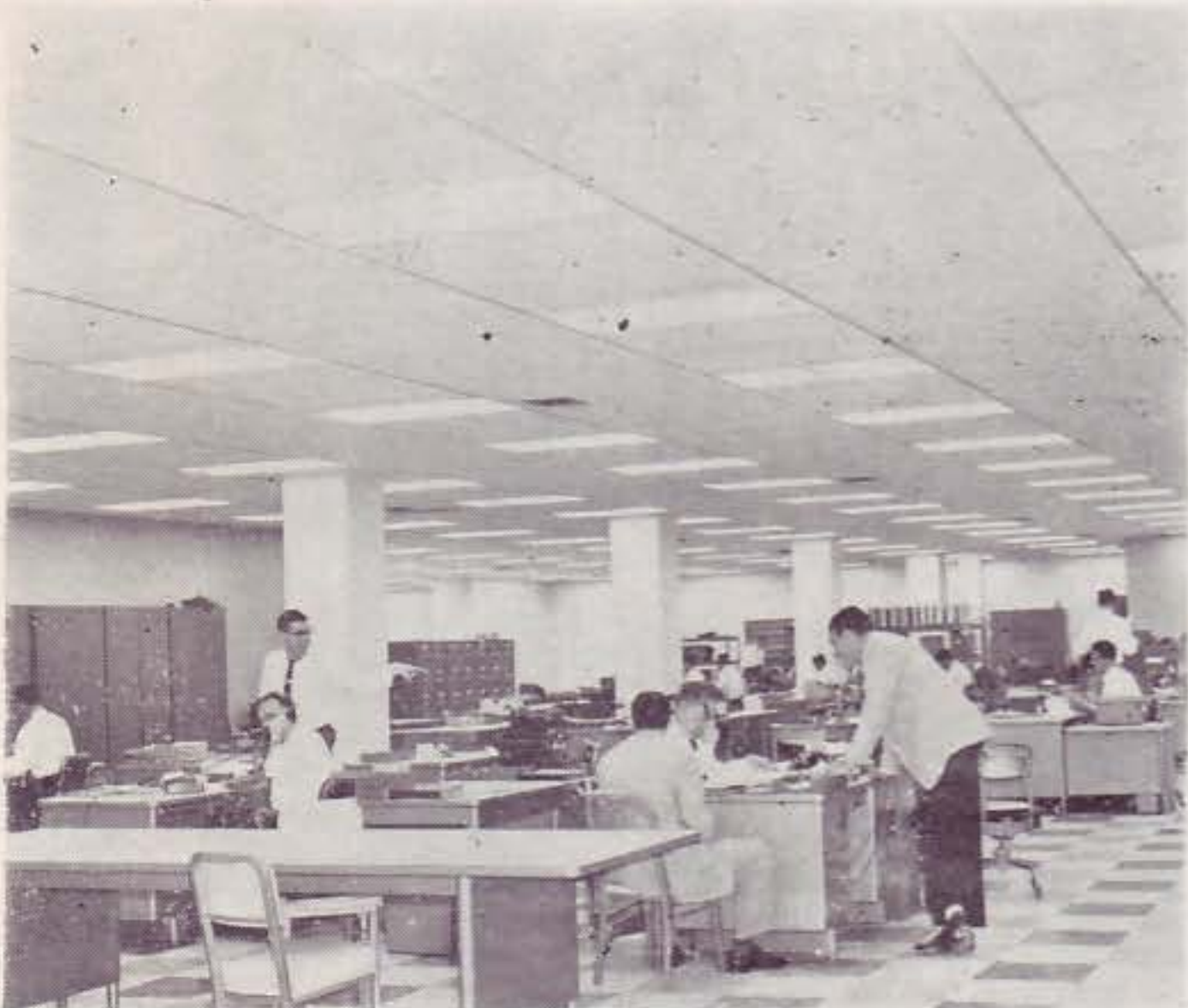
Techos de aluminio corrugado y perforado HANSOTONE de la firma Elof Hansson Inc., New York, de gran efectividad acústica y funcional al permitir un rápido acceso a las instalaciones interiores del falso techo.
