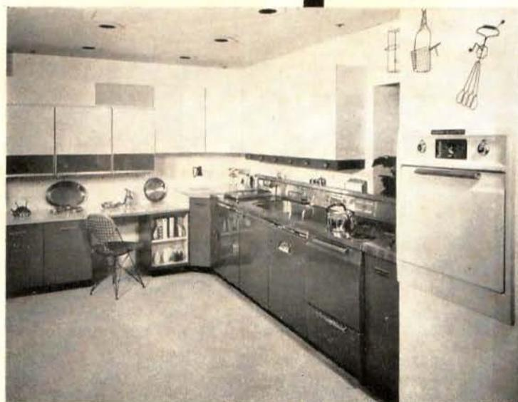
La unidad en la instalación de la Cocina Eléctrica Automática, el Horno Eléctrico empotrado, el Fregadero con Triturador de Desperdicios, la Lavadora-Secadora y la Lavadora de platos, requiere un solo tomacorriente y una conexión para desagüe, para agua fría y para agua caliente.
