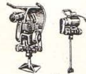
Apisonadoras a gasolina o eléctrica (Catálogo No. 700)
