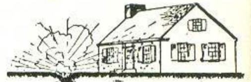
Las bombas de contacto que explotan a corta distancia de un edificio, acribillan y destruyen las paredes exteriores.
