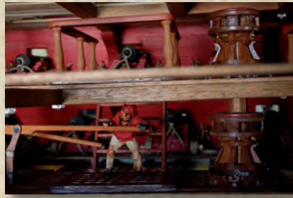
Las bombas de achique de un solo émbolo eran capaces de evacuar 120 toneladas de agua por hora, al tiempo que precisaban de 150 hombres para su manejo.
