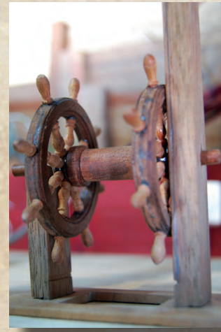
El sistema de pinzote fue reemplazado por la rueda de gobierno, la cual era accionada por los guardines, que la hacían más eficiente al proporcionar 36 grados de osci- lación a babor y estribor.
