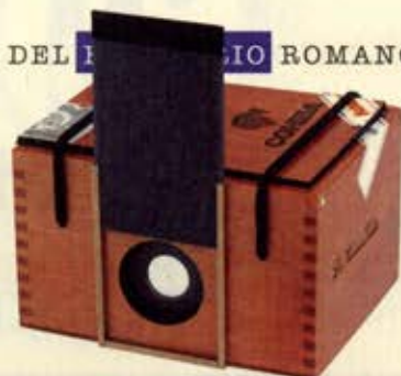
Cámara construida con cajas de tabacos Cohiba Siglo II.
