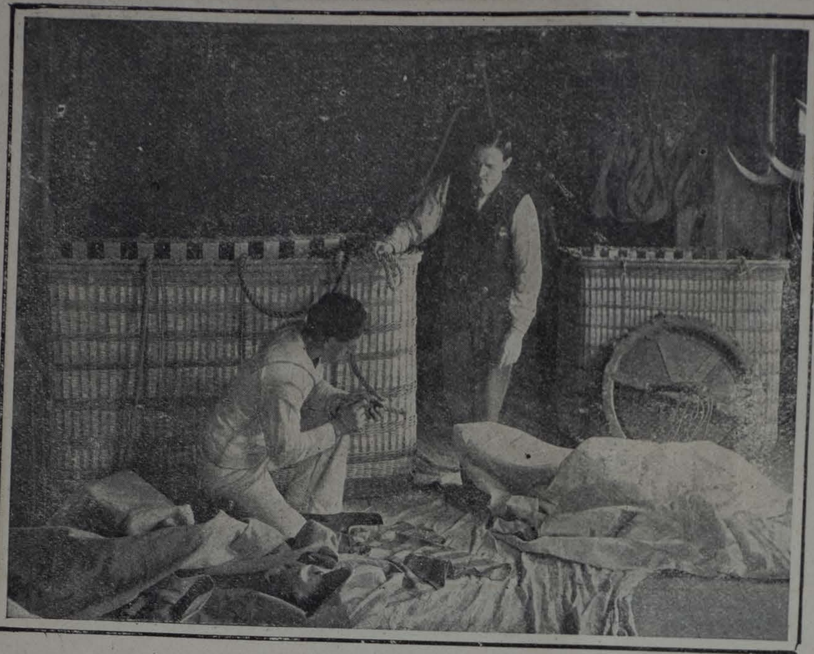
Empalmando las sogas que habrán de unir el cesto con el globo
