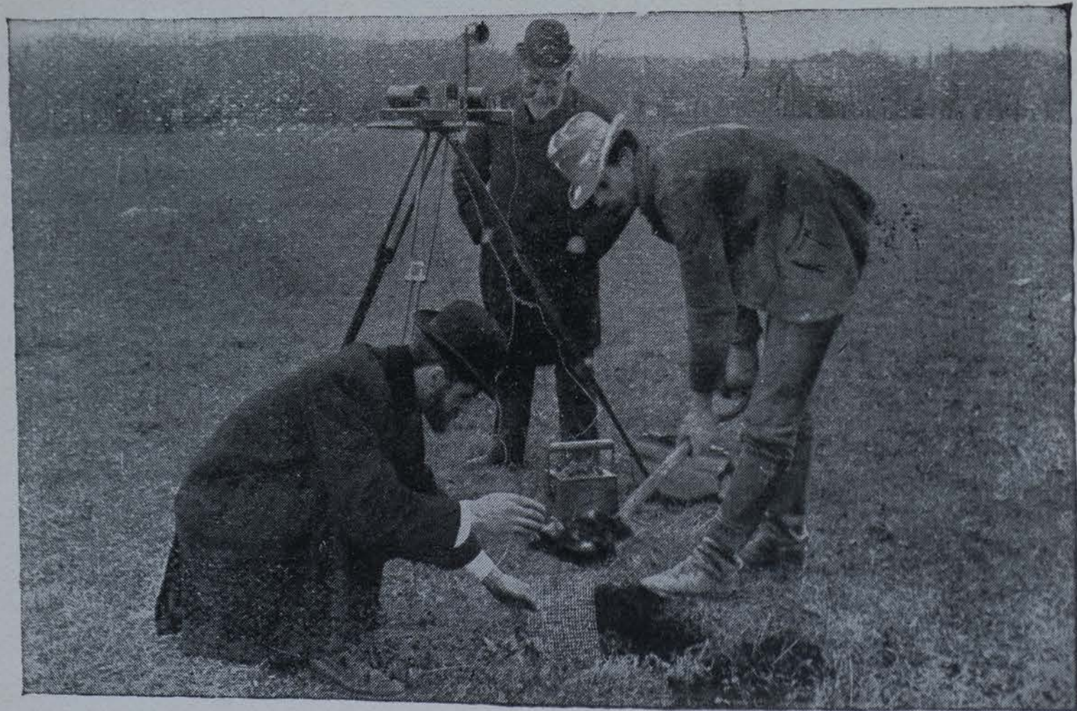
ENTERRANDO EL ALAMBRE DE ZINC DEL APARATO.
