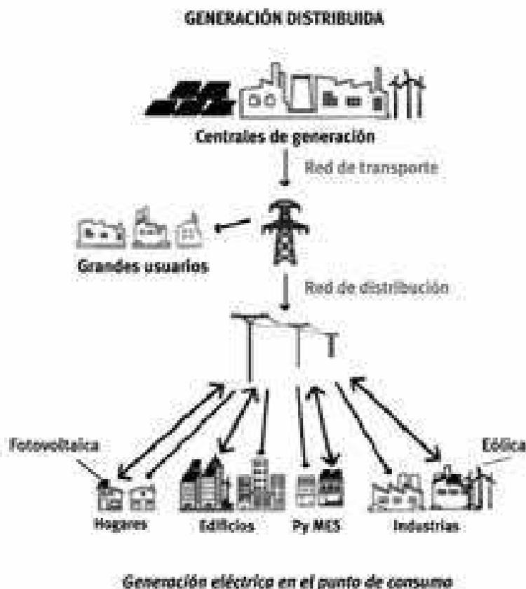
Fig. 2. Esquema de generación distribuida.
