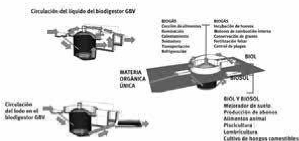
Fig. 1. Productos finales de la tecnología del biogás. Efluentes con valor de uso (biogás, biol y biosol).
