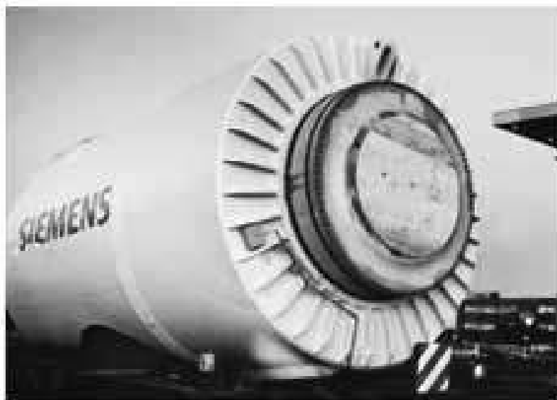
Fig. 7. Siemens Wind Turbine (SWT) -3.6-107. Generador de imanes permanentes refrigerado por aire de accionamiento directo.
