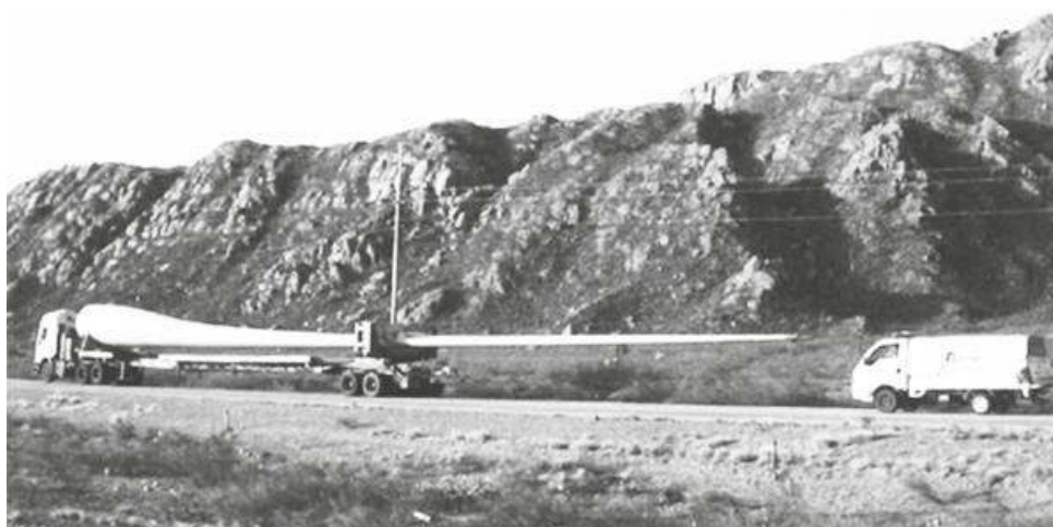
Fig. 2. Transporte de los componentes de los aerogeneradores para su montaje.
