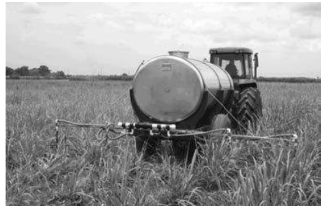
Fig. 3. Utilización de los efluentes del biogás en el fertirriego de la caña de azúcar.
