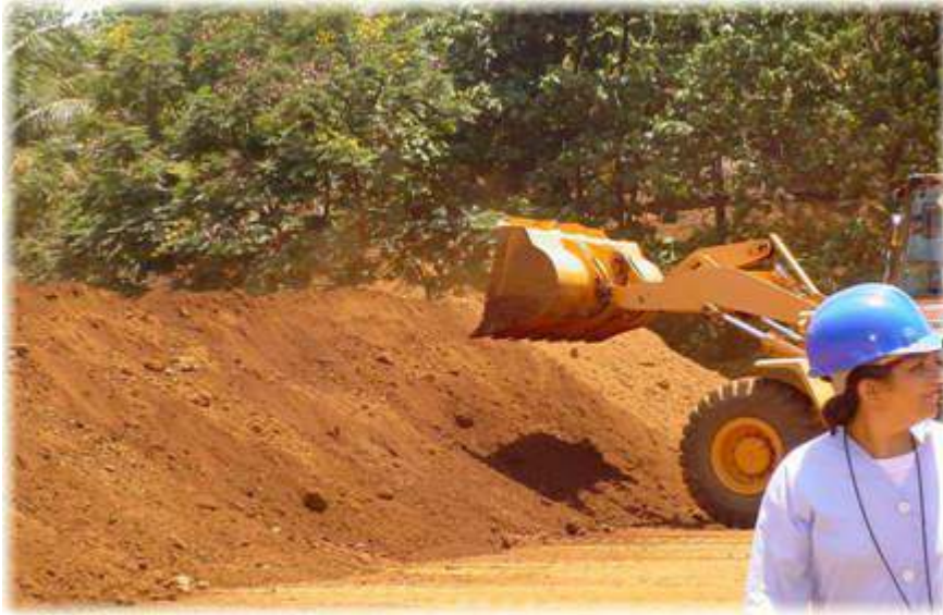
Foto 1. Vista del proceso de remoción del mineral y las mediciones durante la prueba de secado solar y homogeneización a escala semiindustrial.
