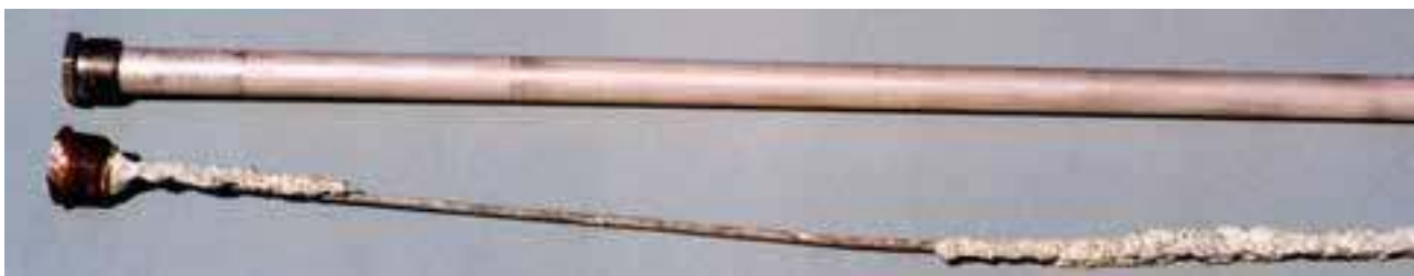
Fig. 21. Ánodo de magnesio (arriba nuevo, abajo agotado).
