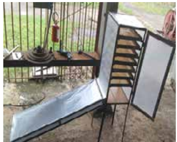
Fig. 2. Secador solar de plantas aromáticas desarrollado en la investigación.
