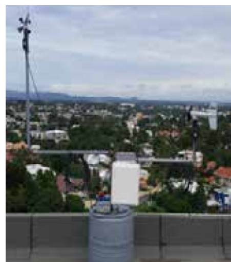
Fig. 4. Anemómetros de veletas Young instalados en INTEC. Elaboración Propia.
