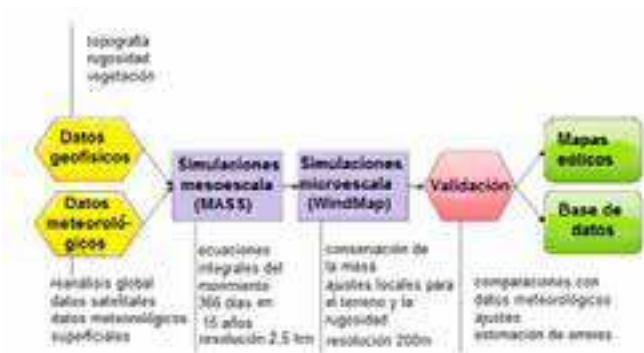
Fig. 4. Esquema del proceso MesoMap [15].
