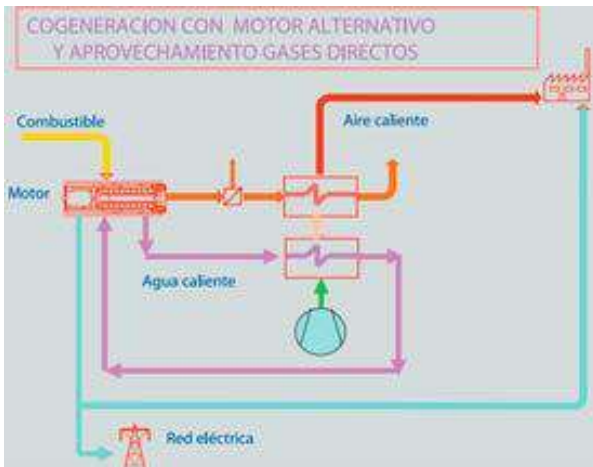
Fig. 5. Diagrama de proceso de planta de cogeneración con motor de gas, para generación de aire caliente [FENERCOM, 2010].
