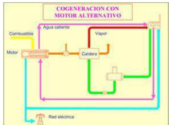
Fig. 4. Planta de cogeneración con motor alternativo [Fraile, 2007].
