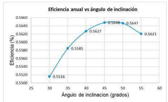
Fig. 7. Variación de la eficiencia para cada ángulo de inclinación del colector.
