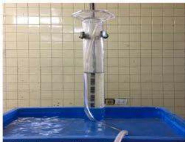
Fig. 11. Uso de probeta invertida como instrumento de medición.
