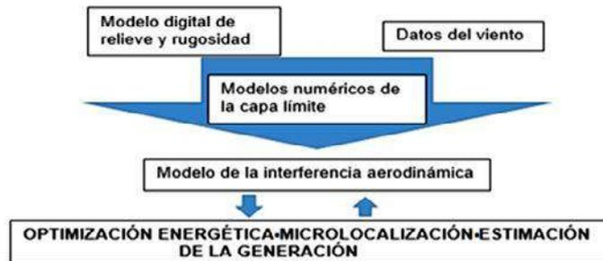
Fig. 2. Proceso para el proyecto de una instalación eólica: mapeo eólico y optimización de la configuración de las turbinas dentro del parque eólico. Fuente: Propia.
