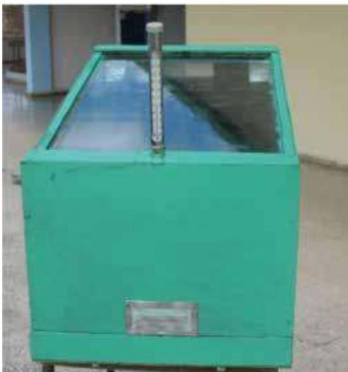
Fig. 4. Secador solar.
