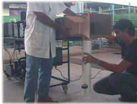
Fig. 2. Mediciones con el modelo de dispositivo vénturi.
