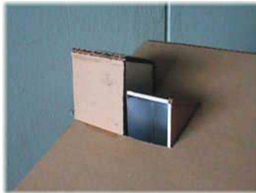
Fig. 3. Salida del conducto de iluminación sobre la cubierta del modelo.
