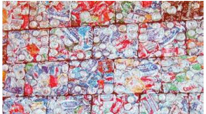
Fig. 5. Enchapes de paneles realizados con latas recicladas.
