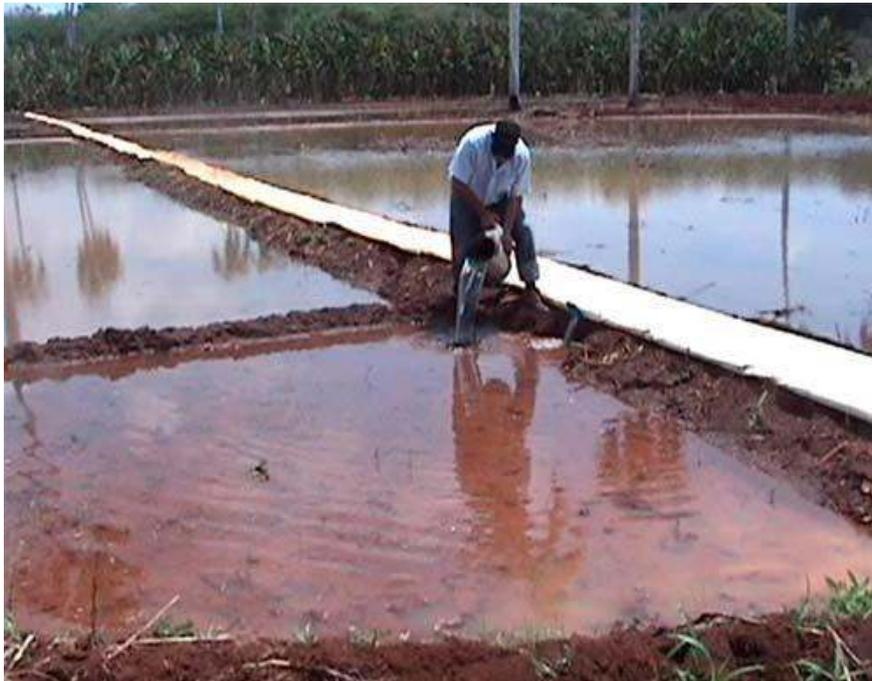
*Fig. 3. Aforo de las compuertas de las mangueras flexibles.*
