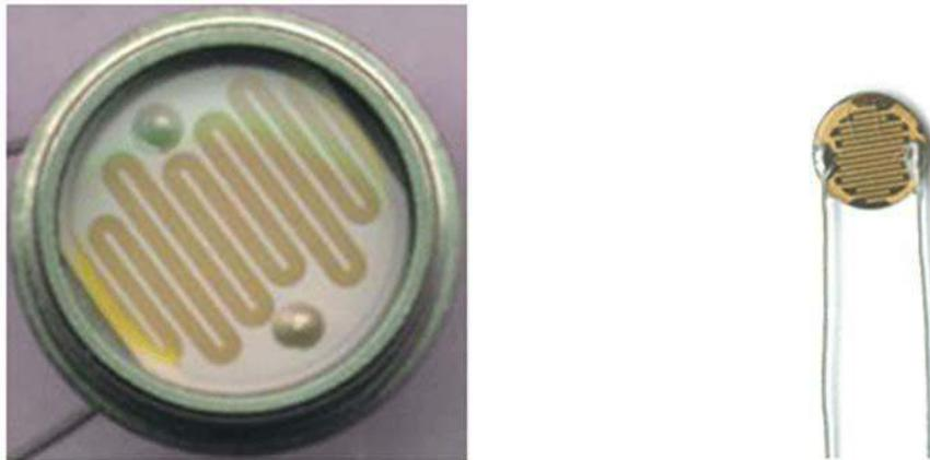
Fig. 2. Foto resistor.
