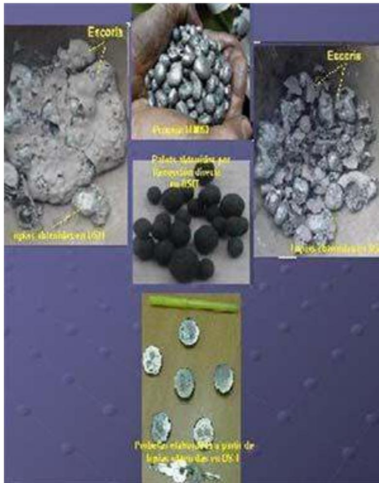
*Fig. 2. Imágenes de los prerreducidos, las lupias y las probetas obtenidas.*
