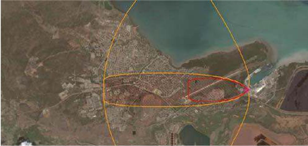
*Fig. 7. Zona de afectación para una fuga de Deq. = 1".
