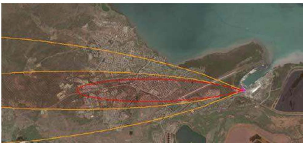
*Fig. 6. Zona de afectación por fallo catastrófico de una bala de amoníaco. Condiciones atmosféricas 5/D. Vientos del Este.*
