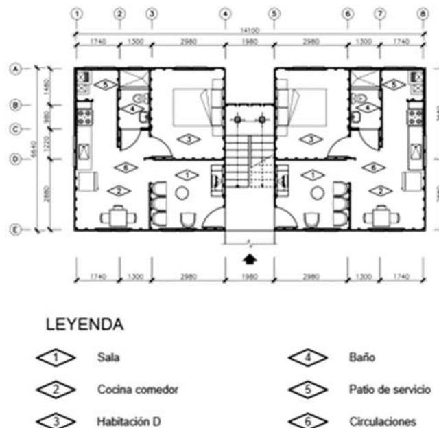
*Fig. 14. Planta del bloque de cuatro viviendas económicas de una habitación cada una. Edificación de dos niveles proyectada empleando el sistema constructivo SERF.*
