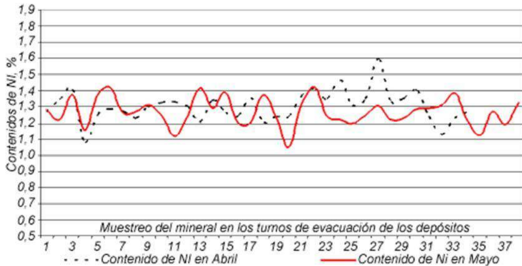
Fig. 3. Contenido de níquel en el mineral evacuado de los depósitos, en abril y mayo de 2006.
