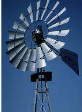
Fig. 1. Molino de bombeo.
