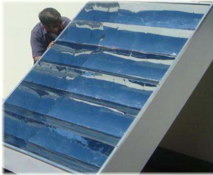
*Fig. 7. El prototipo de seis canales tiene un área de captación de 2 m<sup>2</sup>.*
