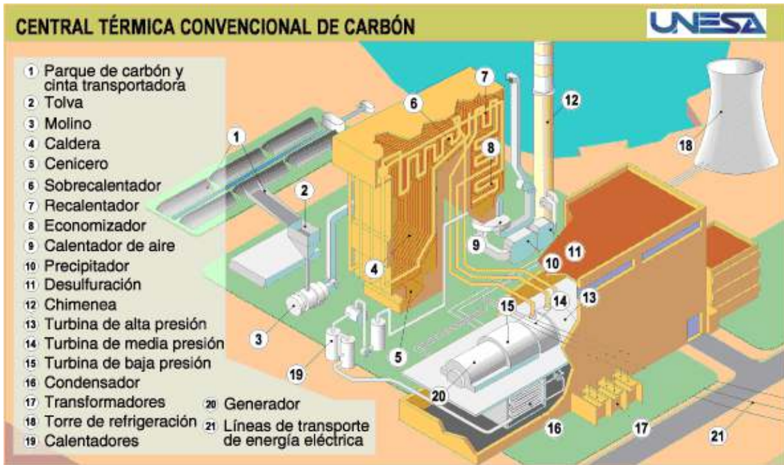
Fig. 1. Esquema de la central térmica convencional de carbón.
