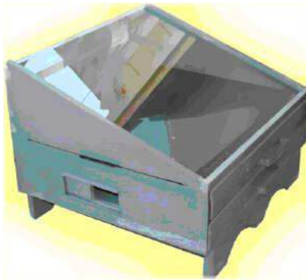
Fig. 1. Secador solar de hollejo de naranja.
