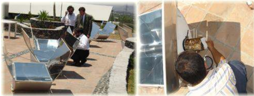
Fig. 2. Hornos solares Tolokatsin 1 de 12 litros de capacidad, empleados en una comida solar para más de 260 comensales.
