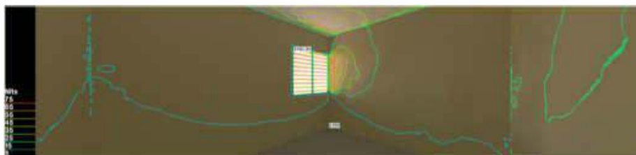
Fig. 9. Efectos de las persianas en la distribución interior de la luz, simulado con RADIANCE.
