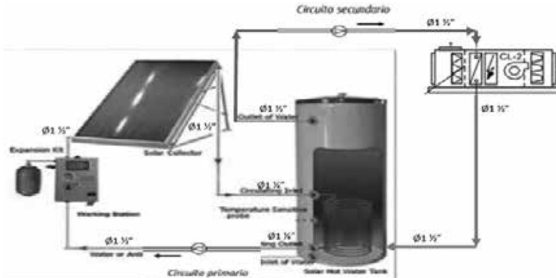
Fig. 5. Esquema de agua caliente de la instalación.
