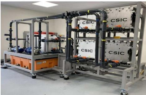
Unos científicos han desarrollado un prototipo de batería de flujo redox de vanadio de 10 kilovatios (kW) para demostrar su viabilidad como sistema de almacenamiento de energía eléctrica a gran escala, dirigido especialmente a las energías renovables, como por ejemplo la solar.
