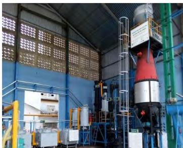
Se acaba de poner en operación una planta que genera energía térmica y electricidad a partir de la cascarilla de arroz. La instalación evita, además, la contaminación ambiental del residuo producto del procesamiento del arroz.
