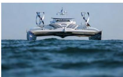
Toyota participa en el proyecto del catamarán Energy Observer al ser la primera embarcación energéticamente autónoma que puede producir ella misma el hidrógeno que precisa para la navegación. Un excelente ejemplo de que con la energía sostenible, tanto fotovoltaica como de aerogeneradores, se puede crear cualquier vehículo que no precisa de los motores diésel contaminantes.
