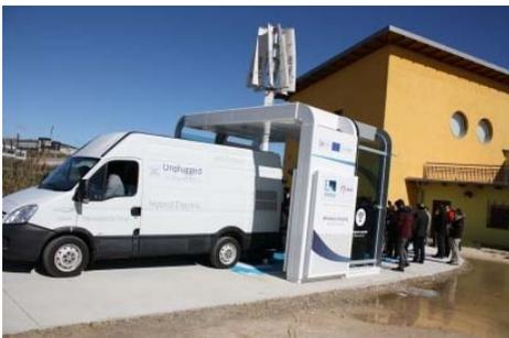
El objetivo principal de Unplugged era construir esta estación de recarga inductiva flexible, que permita la carga de vehículos eléctricos hasta 50 kW; algo clave para facilitar su plena integración en los sistemas de carreteras urbanas, según informa la fundación Circe, uno de los integrantes del consorcio.
