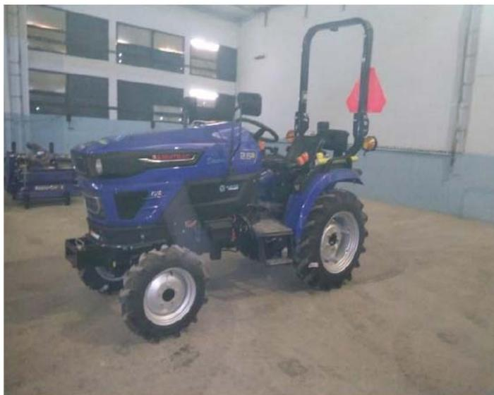
**Figura 6.** Tractor Eléctrico Farmtrac de 21.6 kW de potencia máxima, en proceso de validación en Cuba
