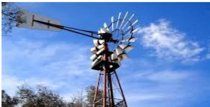
**Figura 5.** Molino a viento para abasto de agua a la ganadería
