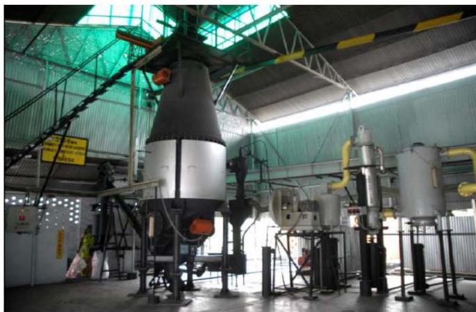
**Figura 4.** Gasificador para la generación de electricidad a partir de biomasa de la cáscara de arroz y otras materias primas, como marabú
