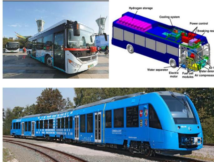
**Figura 6. Arriba:** Autobús que utiliza  $H_2$  y celda de combustible. En el esquema de la derecha se observa que los tanques de  $H_2$  se colocan en la parte superior. **Abajo:** tren que también utiliza  $H_2$  y celda de combustible para suministrar electricidad al motor eléctrico.
