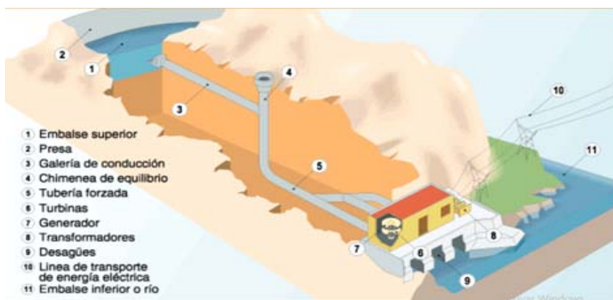
Figura 1. Esquema y componentes de una central hidroacumuladora
