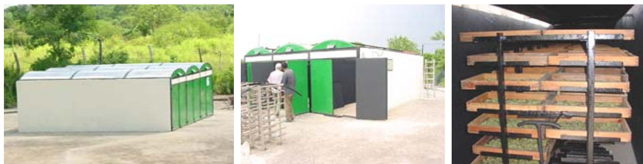
Figura 1. Secador solar de tres cámaras de secado multipropósito. El secador solar está formado por tres cámaras de secado, cada una de las cuales tiene una capacidad de 24 metros cúbicos, o sea, 72 metros cúbicos en total.
