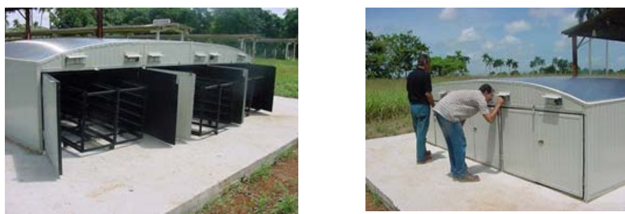
Figura 2. Secador de tres cámaras multipropósito. La altura de esta cámara es de 1 m, el ancho de 2 m, la longitud de 1,5 m, o sea, el volumen total de cada cámara es de 3 m 3 .
