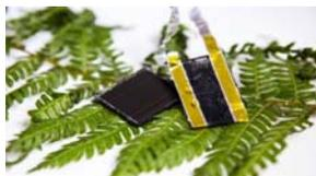
Un prototipo de electrodo basado en el grafeno, inspirado en las hojas del helecho americano, podría aportar soluciones para algunos de los problemas del almacenamiento de la energía solar, que dificultan su implantación como solución energética completa.
