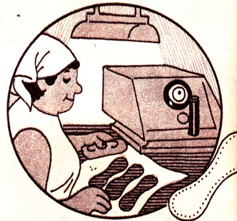
6 Con una maquinita se cortan las piezas para hacer el forro a las pelotas. Cada una tiene 108 huequitos por donde se pasan los hilos a la hora de coserlas.
