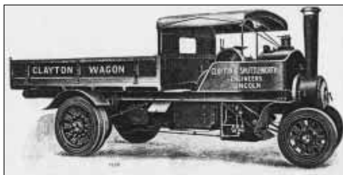
Camión de vapor de 3 toneladas (1,9 m³) empleado en el tiro de áridos
