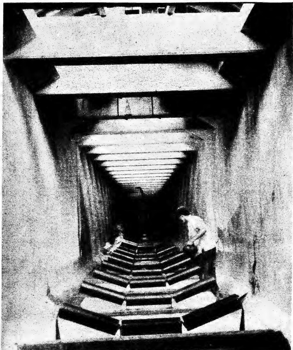
Conductor general de azúcar. Recorrido total desde la tolva al buque: kilómetro y medio
